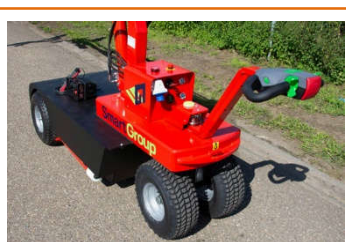
Châssis avec Stabilisateurs et Roues Tout terrain
