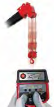
Lors de l'utilisation de télécommande, un système d'amortissement sans à-coups permet les arrêts en douceur
